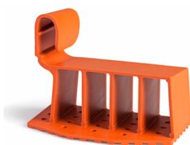
in polipropilene copolimero stabilizzato ai raggi U.V.A.: elemento di rialzo ed ancoraggio, da applicare lateralmente ad ogni tegola. **Non richiede il fissaggio a mezzo meccanico sul piano di posa.**
